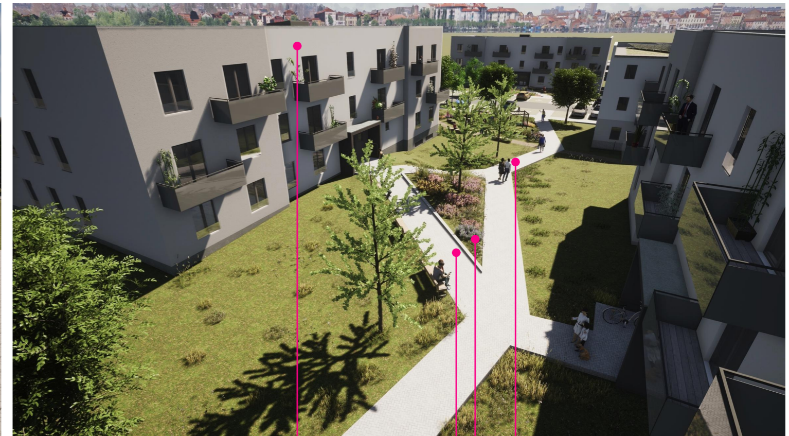
chodník - betonová dlažba zvolena z důvodu možné rozebiratelnosti kvůli křížení se sítěmi technické infrastruktury
