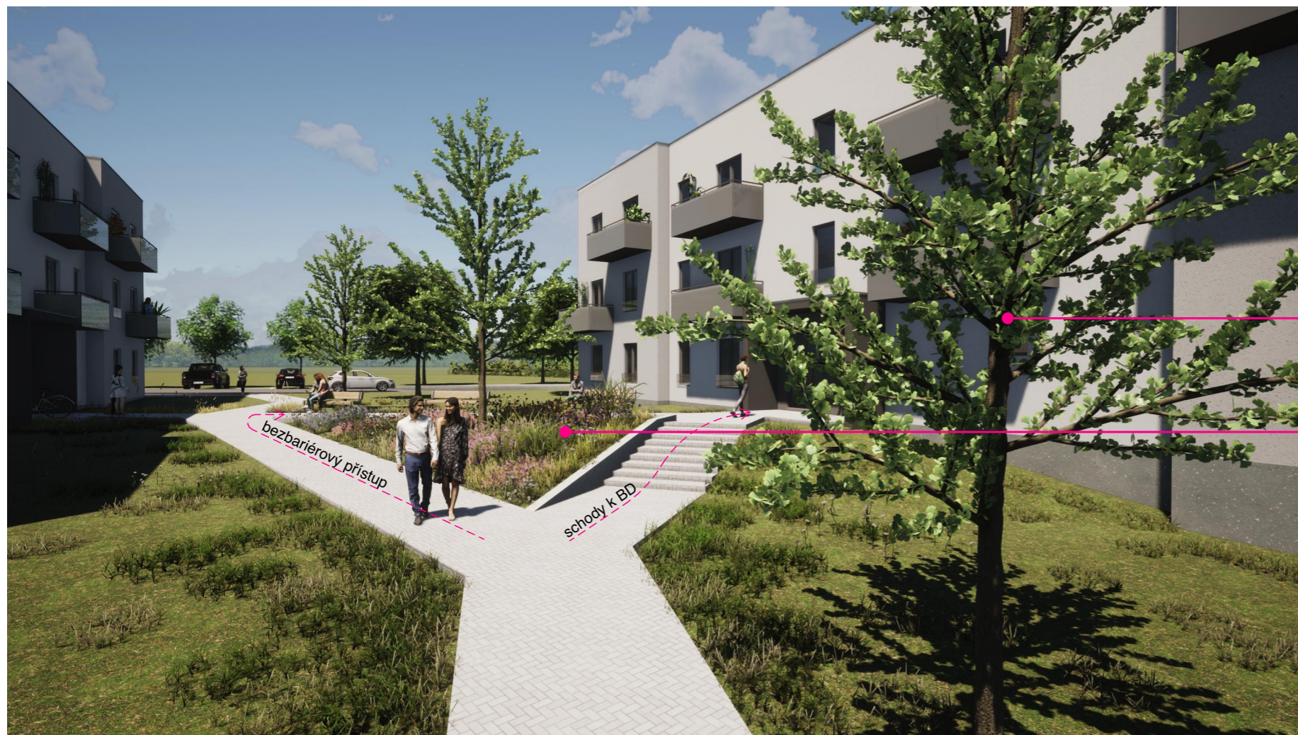
chodník - betonová dlažba zvolena z důvodu možné rozebiratelnosti kvůli křížení se sítěmi technické infrastruktury
